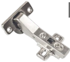
Петля LS угловая 45° с доводчиком, H=0мм, CLIP-ON
