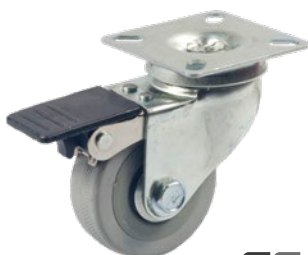
Колесо поворотное на площадке с тормозом d 50, нагрузка 38кг FS
