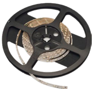
Светодиодная лента LED 2835 120LED/м 12В-9,6Вт/м
