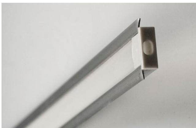
Профиль врез.алюм.K251-2AM д/LED лент 3528/5050 22*6*2000мм+PC матовый+заглушки
